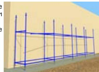
6. Для усиления жесткости конструкции закрепить диагональные элементы (см. Диагональный элемент).
