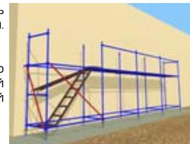
8. Закрепить конструкцию из строительных лесов к стене с помощью анкеров по следующей схеме:
