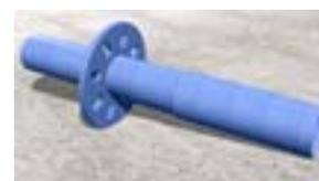
устанавливается на становочную пята. Данный элемент необходим для начала монтажа лесов и служит для установки вертикалей (как «подставка»). Имеет фланец для крепления горизонталей с соседними аналогичными элементами, что дает возможность обвязывать леса горизонталями на малой высоте (которая выставляется становочной пятой).
